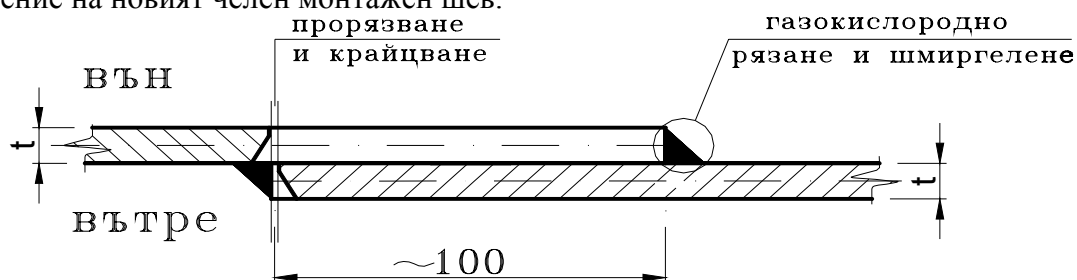
фиг. 4 Схема за първоначална подготовка на съществуващото снаждане с препокриване за преминаване към челен монтажен шев
