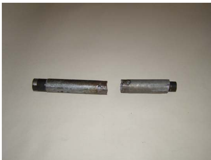
фиг. 5 Разрушен челен шев в стоманен обръч
