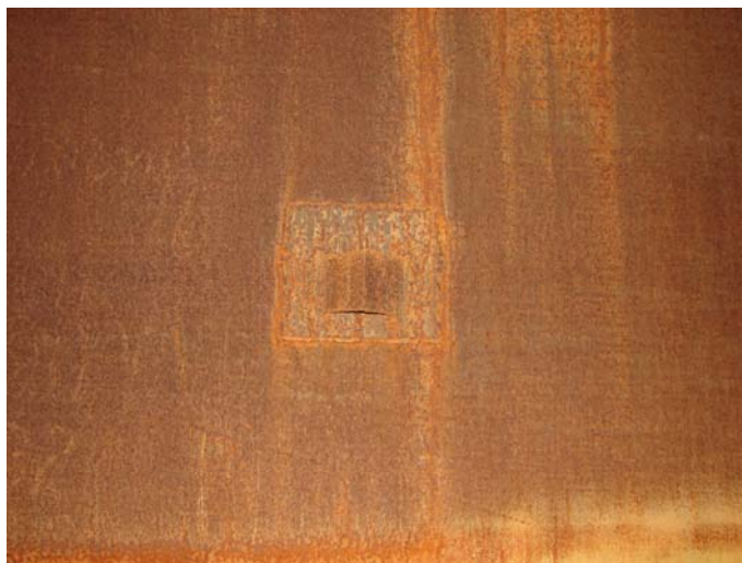
Фиг. 3. Монтажни приспособления по корпуса, които не са премахнати
